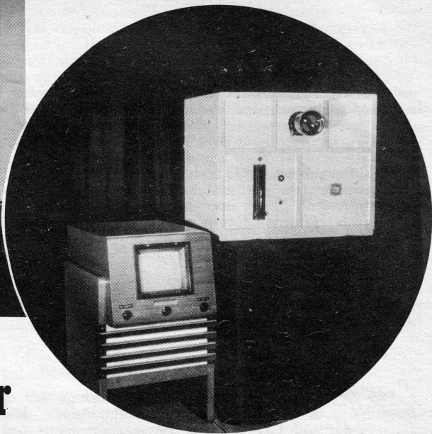
Unten: Eine Fernseh-Röhre, die in dem Kasten verborgen ist, zeichnet ein 5x6 cm großes Bild, das durch außen sichtbare Optik vergrößert und auf einen Schirm geworfen wird.
